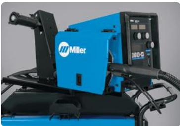
Los acoplamiento giratorios para el alimentador de un solo alambre brindan comodidad y funcionalidad, ya que eliminan el desgaste de la antorcha y del conjunto del revestimiento. Se mueven junto con la antorcha MIG, por lo que el operario puede ver la parte frontal del alimentador y los parámetros seleccionados.
