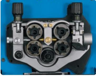
Los rodillos de accionamiento y los sensores de presión equilibrada enderezan perfectamente el alambre y ofrecen una capacidad de alimentación constante, lo que permite un mejor desempeño de soldadura.
