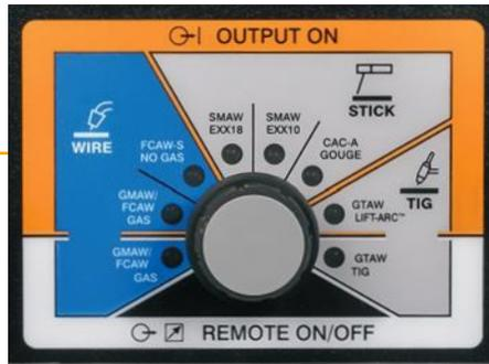
**Indicador de proceso LED.** Las opciones de procesos del panel delantero se iluminan con un LED que identifica el proceso activo. Esto permite que el proceso de soldadura seleccionado se vea lejos de la fuente de alimentación. Incluye un modo de corte por arco de carbono para una mejor estabilidad y un mayor control del arco y dos modos con electrodo (EXX10 y EXX18) diseñados para reducir las salpicaduras y mejorar el inicio del arco.
