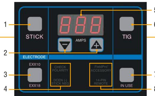
1. Botón de selección del proceso de soldadura convencional con electrodos
