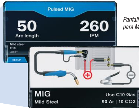
Diagrama de conexión en pantalla para MIG con gas C10
