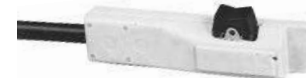
RMLS-14 (enchufe de 14 clavijas) 129337 Interruptor basculante de contacto momentáneo y mantenido para el control del contactador. Empújelo hacia adelante para el contacto mantenido y hacia atrás para el contacto momentáneo. Incluye cordón de 26,5 pies (8 m) con enchufe.
